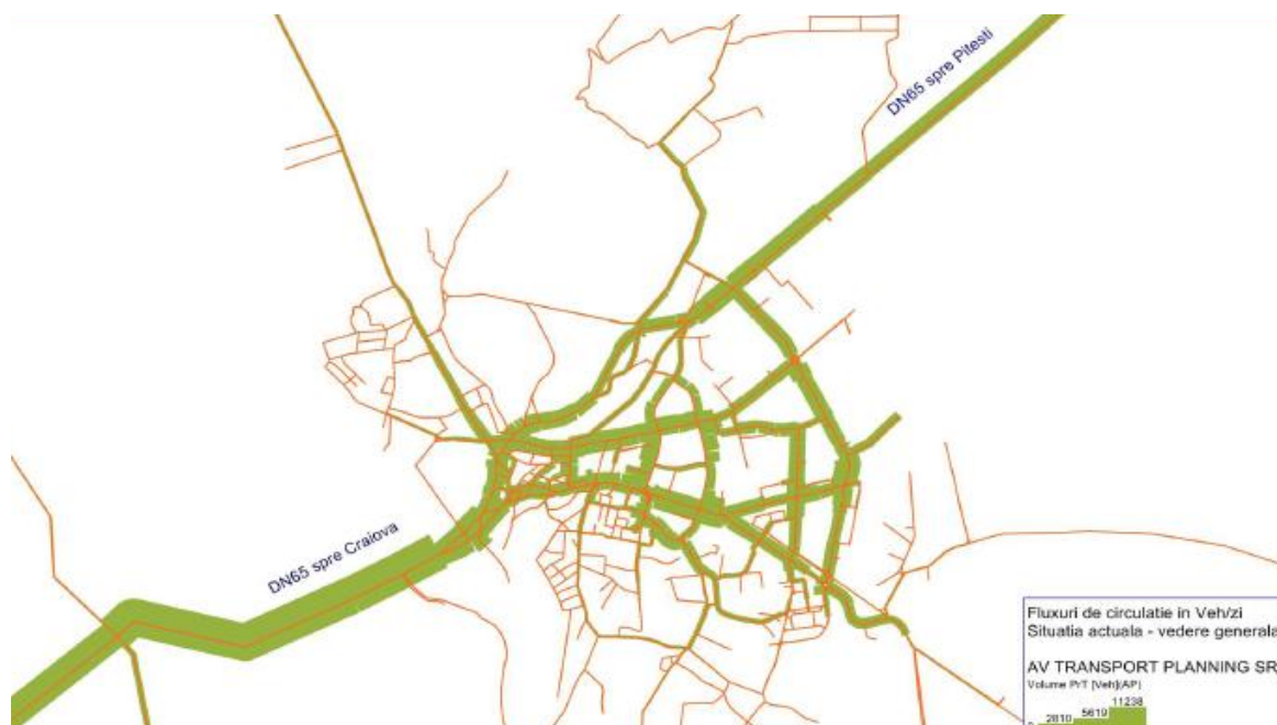
Fig. 22 - Fluxuri de circulație veh/zi - vedere generală
